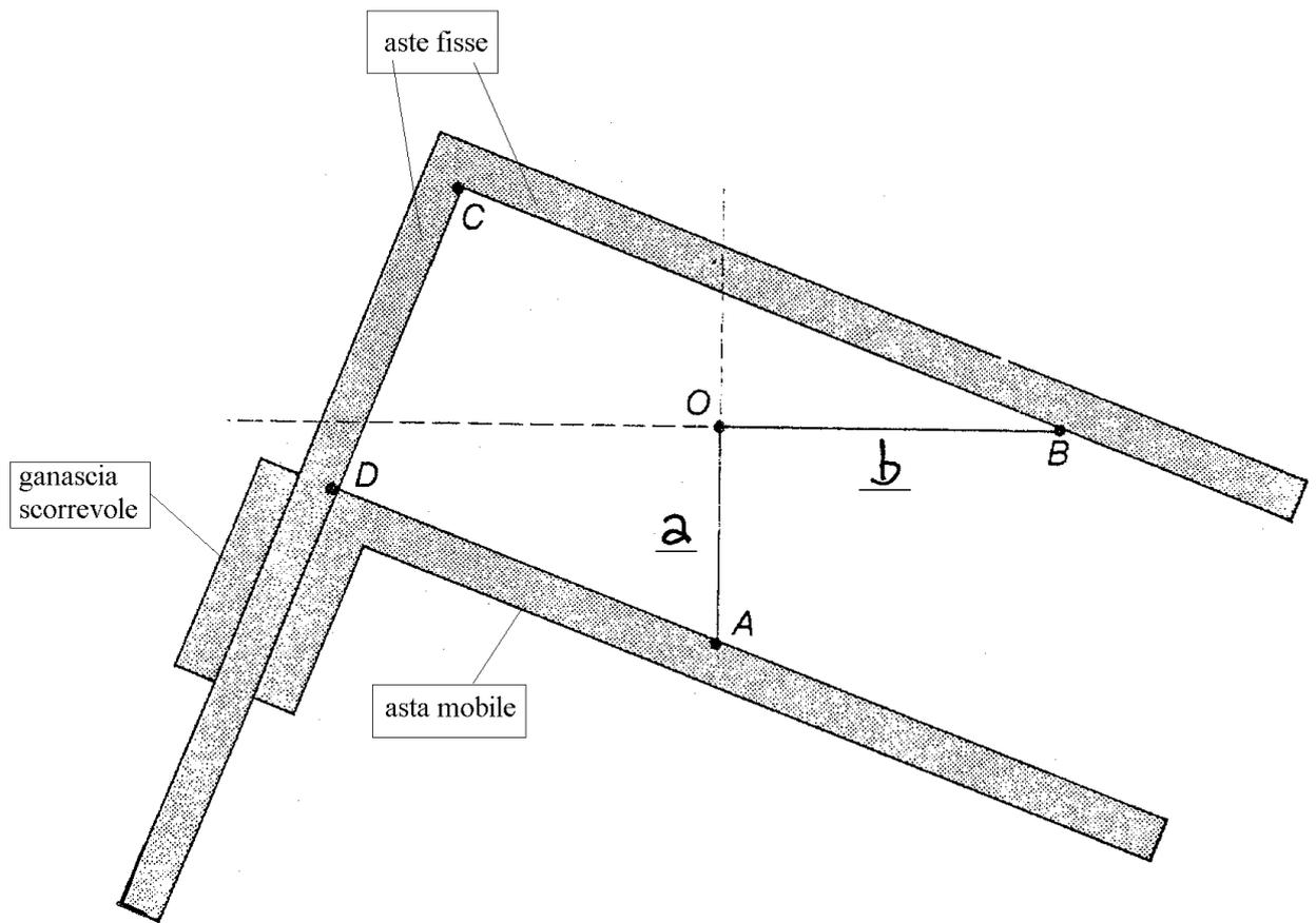
Lungo il suo lato verticale scorreva una ganascia collegata a un'asta mobile e parallela a quella fissa orizzontale.
