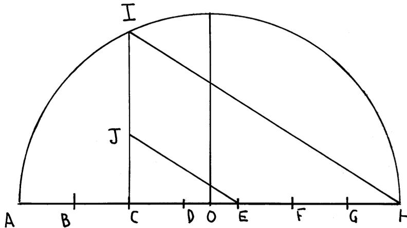
Su di una retta orizzontale riportare per *sette* volte la lunghezza AB dello spigolo del cubo da duplicare: sono stabiliti i punti C, D, E, F, G e H.
