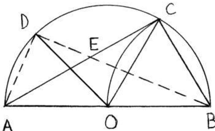
Disegnare una semicirconfenza AB con raggio OA. Facendo centro in B con lo stesso raggio tracciare un secondo arco che va da O fino a fissare il punto C.
