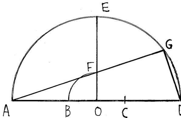
Tracciare il diametro AD e dividerlo in *tre* parti uguali: i segmenti AB, BC e CD hanno lunghezza uguale a quella dello spigolo del cubo da duplicare.
