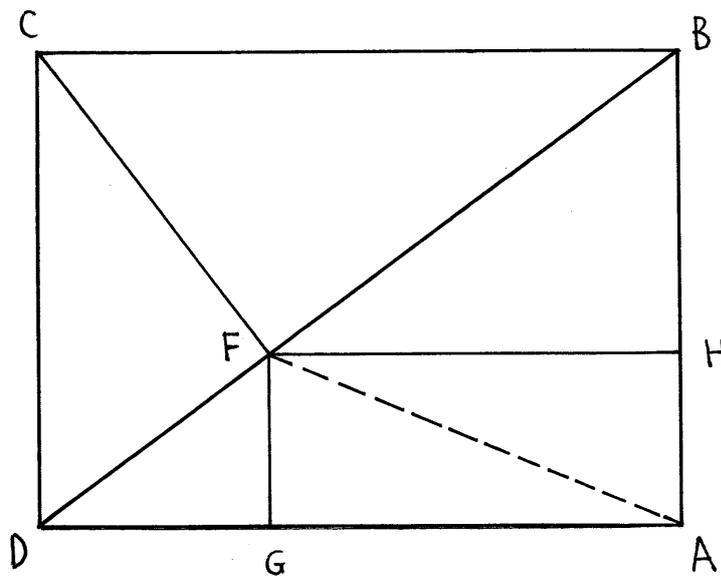
DB è una delle sue due diagonali. Dal vertice C abbassare la perpendicolare a DB: è CF. Dal punto F condurre le parallele ai lati di ABCD: sono FG e FH. FA è la diagonale del rettangolo GFHA.
