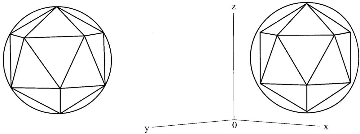
L'assonometria è *dimetrica* perché due degli angoli fra gli assi tracciati sul piano di proiezione sono praticamente uguali e ampi  $\sim 95^\circ$ :
