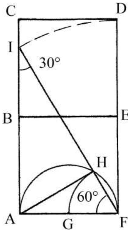
La sua costruzione è ottenuta con il metodo che segue: il punto G è il medio di AF. Fare centro nel punto G e, con raggio  $GA = GF$ , disegnare una semicirconfenza. Con la stessa apertura fare centro in F e tracciare un arco da G fino a intersecare la semicirconfenza in H.
