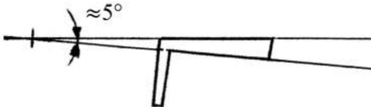
I due bordi del cateto verticale convergono anch'essi di un angolo abbastanza piccolo:
