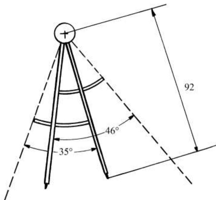
La lunghezza delle aste è stimata in 92 cm. La stabilità dello strumento durante il suo uso era assicurata dalla presenza di due *settori*, simili a quelli impiegati nei compassi metallici utilizzati nelle officine meccaniche per disegnare su superfici dure:
