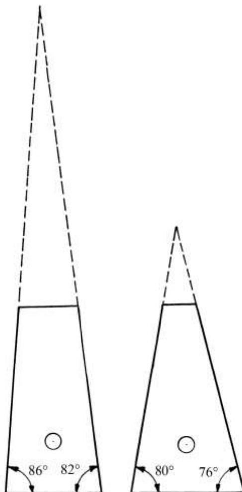
Le due squadre hanno forma di trapezio scaleno e risultano dal taglio di due triangoli scaleni, ma *quasi* isosceli, lungo linee parallele alle loro basi: entrambe presentano un foro circolare il cui centro non coincide con il baricentro.
