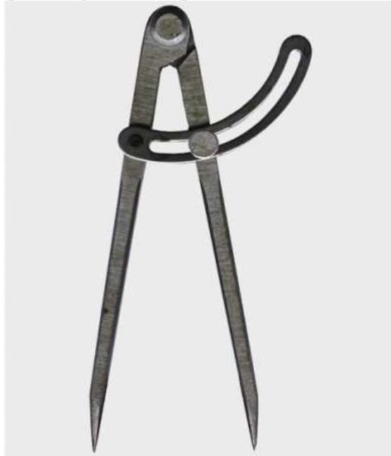
I due settori del compasso di Offa permettevano aperture di 35° e di 46°.
