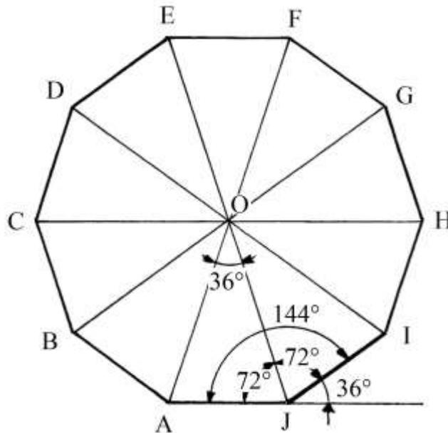
Gli angoli *complementari* di  $36^\circ$  e di  $54^\circ$  possono essere ricavati, con un'accettabile approssimazione, con l'impiego di una squadra a forma di triangolo rettangolo, con cateti lunghi in proporzione 8 e a 11 unità:
