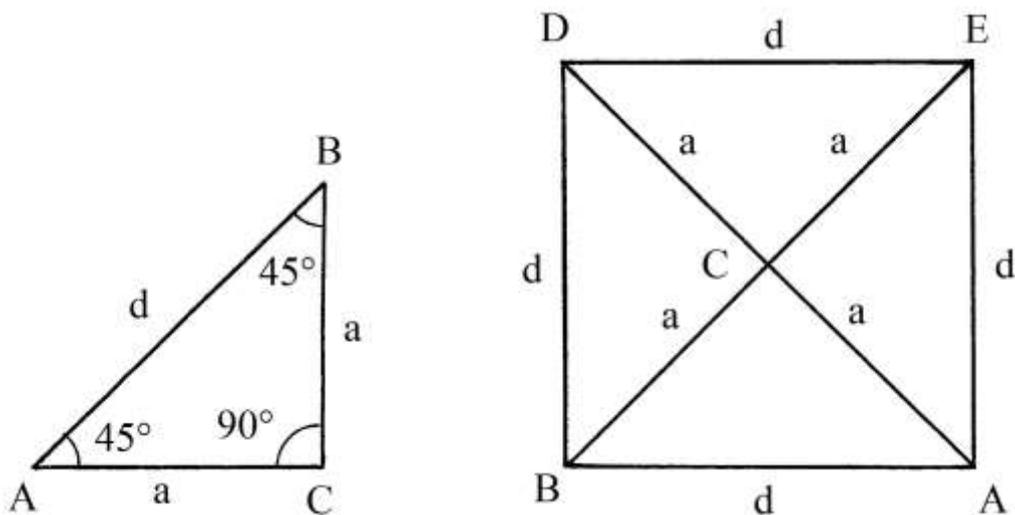
Utilizzando solo due triangoli rettangoli isosceli, ad esempio  $BDE$  e  $BEA$ , si ricavano due squadre a  $45^\circ$  di maggiori dimensioni (le lunghezze sono moltiplicate per  $\sqrt{2}$ ):
