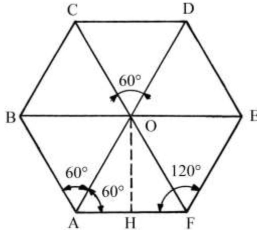
In figura gli angoli sono indicati di ampiezza uguale a  $60^\circ$ , con una leggera approssimazione per difetto rispetto al valore calcolato di  $60,255^\circ$ .
