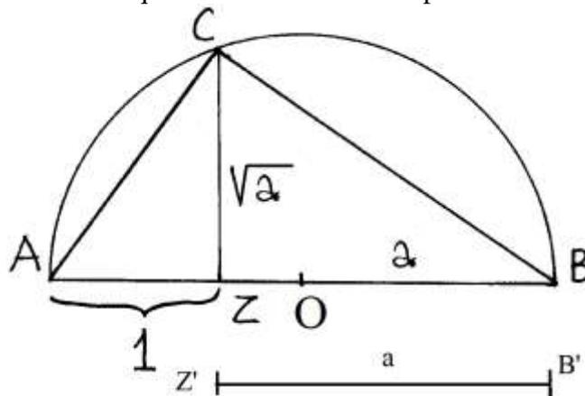
Disegnare una linea orizzontale e su di essa fissare tre punti A, Z e B tali che AZ sia la lunghezza unitaria e ZB quella di un segmento di lunghezza  $a$ .
