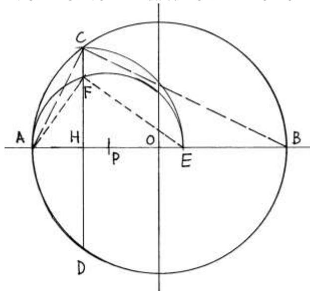
Fare centro nel punto H e con raggio HC disegnare un arco da C fino a intersecare il diametro AB in un nuovo punto, E.
