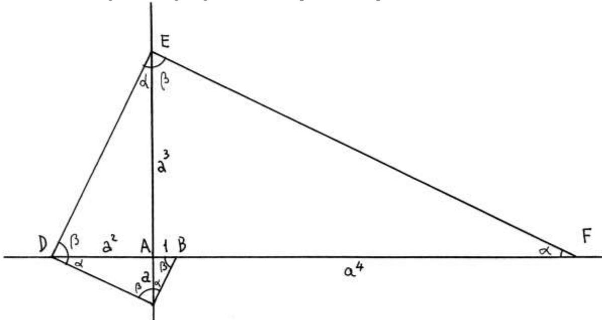
La spirale delle potenze è *reversibile* e cioè è possibile graficamente ricavare la lunghezza di  $a$  a partire da due sue potenze, come mostra l'esempio del triangolo, ADE nella figura, di cui sono note le lunghezze dei cateti  $AD = a^2$  e  $AE = a^3$ :
