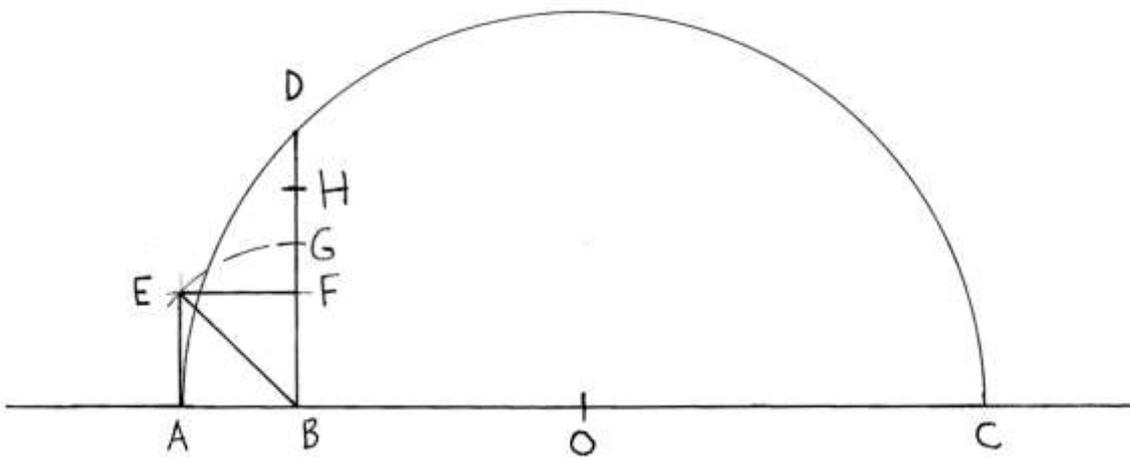
Tracciare una retta orizzontale e fissarvi *tre* punti A, B e C a distanze *convenzionali* uguali a  $AB = 1$  e  $BC = 6$ . Il segmento AC è lungo  $1 + 6 = 7$
