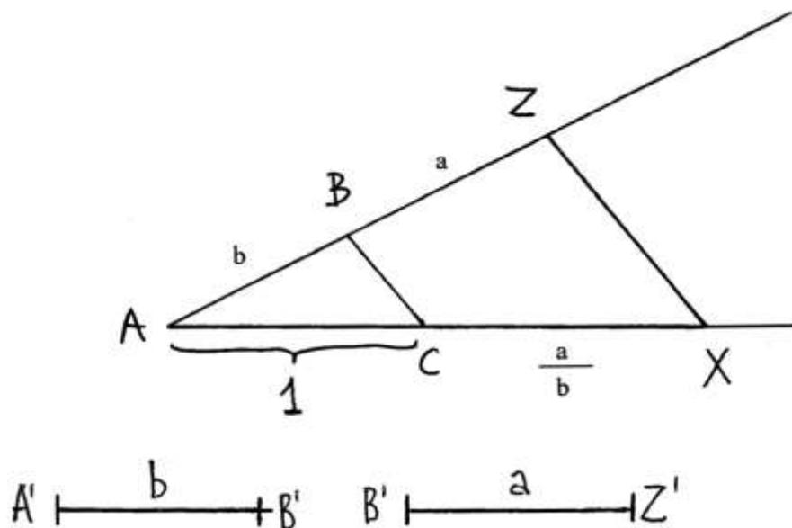
Applicando di nuovo la regola della stessa scala di rappresentazione, disegnare una semiretta orizzontale da A verso destra e fissarvi il punto C, in modo che AC sia la lunghezza dell'unità di misura scelta.
