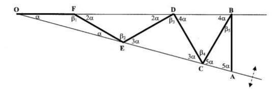
Con questo metodo può essere realizzata la costruzione di poligoni regolari con un ampio ventaglio di numeri di lati. La figura che segue descrive i casi con differenti numeri di aste, da 2 a 7:
