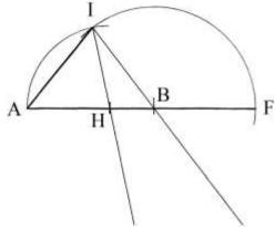
Fare centro in H e con raggio HB disegnare un arco a partire da A e con centro in B e raggio BF tracciare un secondo arco che taglia il primo nel punto I. AI è il primo lato dell'ettagono e F ne è un altro vertice.
