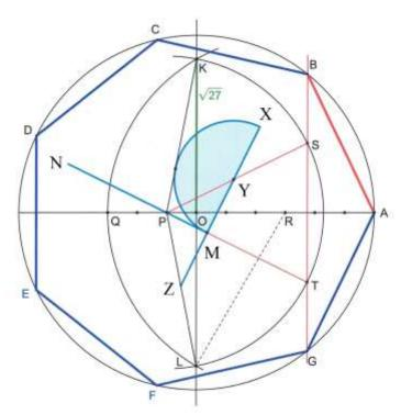
Eccone la spiegazione. Disegnare una circonferenza di centro O e raggio OA lungo convenzionalmente *sei* e i due diametri perpendicolari che si intersecano in O.
