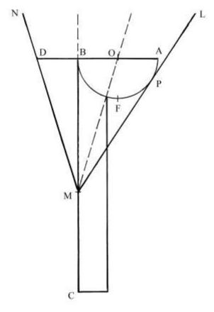
È dato l'angolo NML che deve essere tripartito. Lo strumento è posizionato in modo che il vertice M sia sullo spigolo BC del manubrio, il lato MN passi per D e il lato ML sia tangente al semicerchio in un punto, P.
