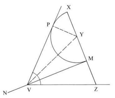
Lo strumento deve essere posizionato sull'angolo in modo che il vertice Z giaccia sul lato orizzontale, il lato inclinato dell'angolo sia tangente nel punto P al semicerchio e la maniglia MN passi per il vertice V.
