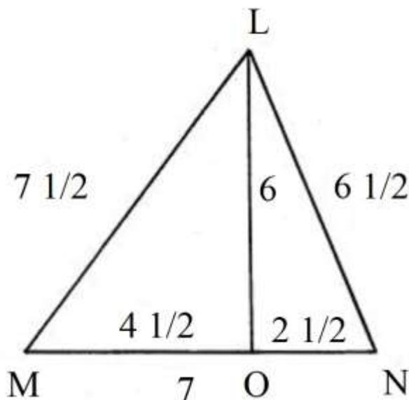
Per ricavare l'altezza LO Bartoli usa una procedura che, pur senza citarlo, applica la formula di Erone per calcolare le lunghezze delle proiezioni dei lati LM e LN sulla base MN, che sono rispettivamente i segmenti MO e NO. Ecco i suoi passi:
