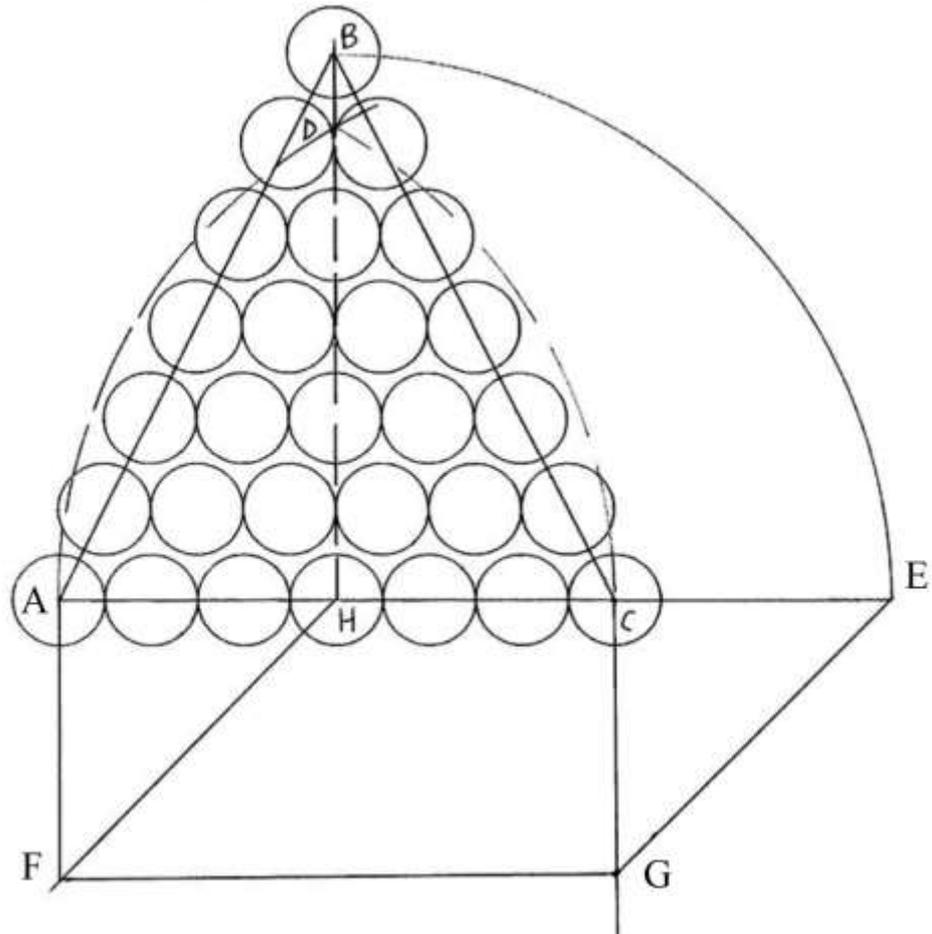
Ecco descritta la precedente costruzione. Tracciare l'altezza BH; fare centro in A e in C e, con raggio AC, disegnare due archi: essi si intersecano in un punto, D, collocato sull'altezza BH. Questa è la dimostrazione geometrica che ABC è un *triangolo isoscele*.
