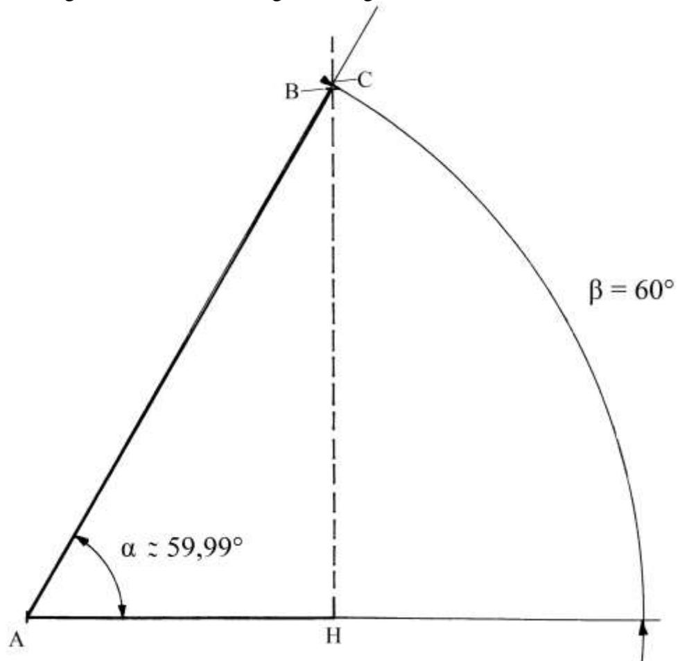
$ABH$  è un triangolo 41-71-82 e l'angolo  $\alpha$  è ampio  $59,99^\circ$  e cioè *quasi*  $60^\circ$ .  $ACH$  è un triangolo rettangolo uguale a metà di un triangolo equilatero e l'angolo  $\beta$  è ampio  $60^\circ$ . I segmenti  $AB$  e  $AC$  risultano vicinissimi.
