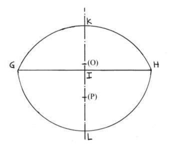
Essa è generata dall'intersezione di due cerchi di centri O e P e raggi  $r_1 = OG$  e  $r_2 = PG$ . I due segmenti circolari hanno frecce IK e IL che formano due segmenti *adiacenti*. I centri dei due cerchi giacciono sulle frecce.
