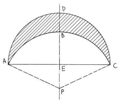
Ricostruendo la situazione si ha che l'angolo APC è ampio  $130^{\circ}$  e il raggio dell'arco ABC è lungo PA = PB = PC.
