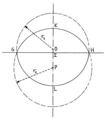
Conoscendo le lunghezze della corda e delle due frecce è possibile calcolare le aree dei due segmenti con il metodo già utilizzato in precedenza.
