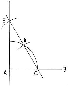
Con raggio a piacere -AC – fare centro in A e disegnare in senso antiorario un arco a partire dal punto C. Con la stessa apertura fare centro in C e tracciare un arco che taglia il primo in D.
