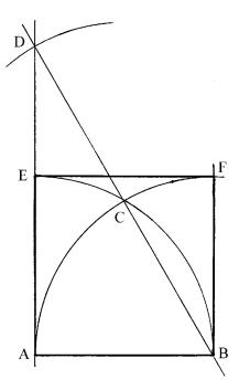
Fare centro nei punti A e B con raggio AB e tracciare due archi che si incontrano nel punto C. Fare centro in C con la stessa apertura e disegnare un altro arco.
