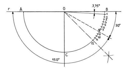
Su di una retta orizzontale, *r*, fissare un punto, O, e da questo abbassare la perpendicolare. Fare centro in O e tracciare una semicirconferenza che stabilisce i punti A, B e C.
