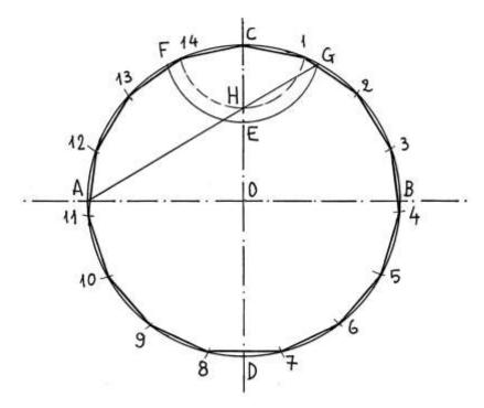
Tracciare i due diametri perpendicolari AB e CD. Dividere in *due* parti uguali il raggio OC: è stabilito il punto E. Fare centro in C e con raggio CE disegnare un arco che taglia la circonferenza nei punti F e G; tracciare la corda AG: essa incontra OC in un punto, H.
