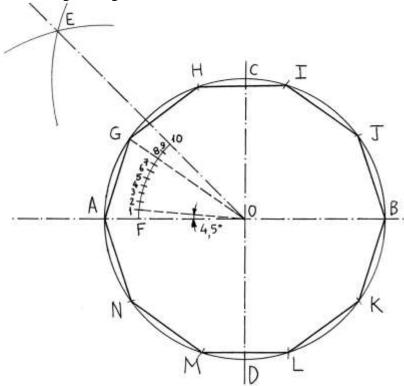
Tracciare due diametri fra loro perpendicolari: sono AB e CD. Essi si intersecano nel punto O, centro del cerchio da disegnare con raggio OA.
