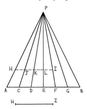
Tracciare un segmento parallelo a AB e fissare il punto H sul lato AP e fare sì che il vertice I cada sul lato FP: HI è così diviso in quattro parti uguali.
