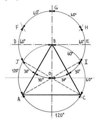
Per i punti O e B tracciare l'asse di simmetria verticale e per il punto B un asse orizzontale perpendicolare al primo.
