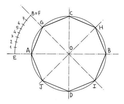
Volendo comunque dividere in *otto* parti uguali l'angolo di 45° si può ottenere un risultato esatto con una costruzione che implica una successione di bisettrici degli angoli via via dimezzati, come mostra la figura:
