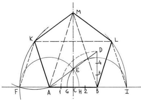
Con raggio AM fare centro nei punti A e B e disegnare gli archi LI e KF: ciò prova che AI e BF sono lunghi quanto le diagonali del pentagono già tracciate.
