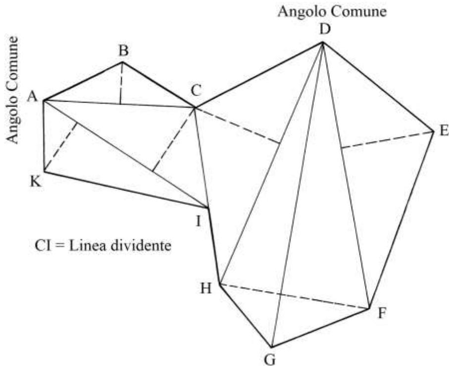
Per tracciare tutte le corde occorrenti e che siano contenute all'interno del poligono, è necessario dividerlo in *due* parti: nell'esempio provvede allo scopo la corda CI, definita da Forestani “Linea dividente”: essa separa ABCIK da CDEFGHI.
