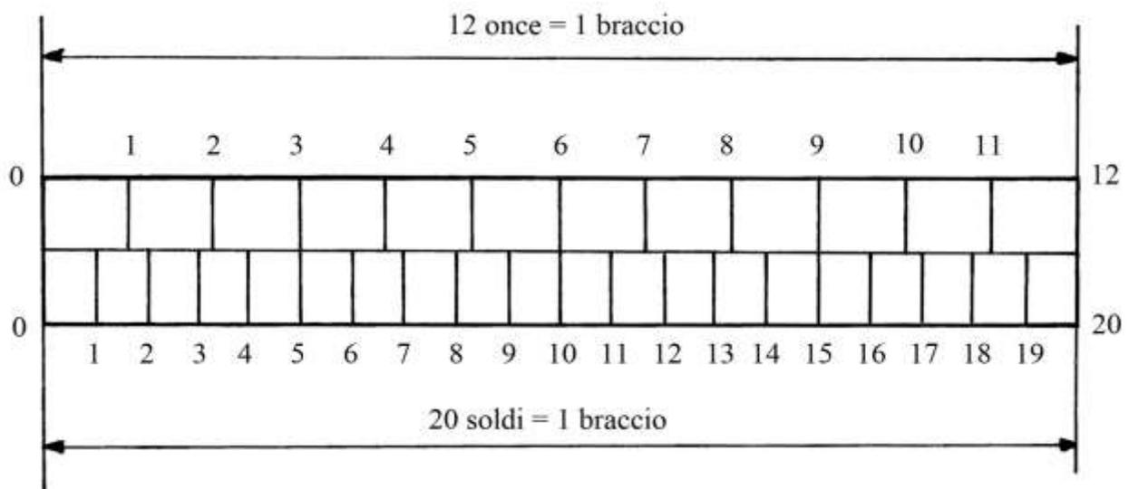
Il preciso calcolo del peso dell'olio costringeva ad operare con i *rotti*, i numeri frazionari. Per rimediare alle difficoltà, Forestani propose di misurare le dimensioni delle pile da olio usando il metodo dei *punti* già applicato alle botti e fissò alcune equivalenze:
