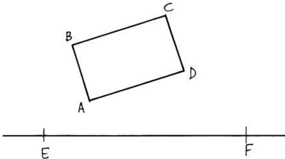
I lati del quadrilatero non sono paralleli o perpendicolari alla retta passante per i punti E e F. Un primo metodo impiegato per il rilievo è descritto nella figura che segue:
