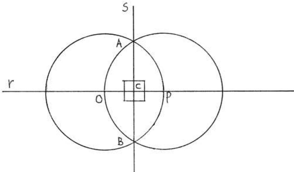
Per riprodurre la costruzione, fissare sulla retta **r** due punti, O e P, a distanza uguale al raggio delle due circonferenze.
