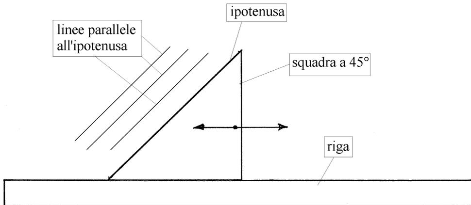
Il grafico qui sopra dimostra che si tratta di un'applicazione del metodo della *diagonale*. Con questa costruzione si realizza una *triangolazione* o si verifica una triangolazione già tracciata.
