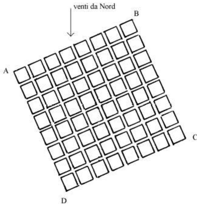
Ad esempio, i venti provenienti da Nord (vedere la figura qui sopra) colpivano le facciate orientate secondo AB con una direzione obliqua e i loro effetti erano attutiti.
