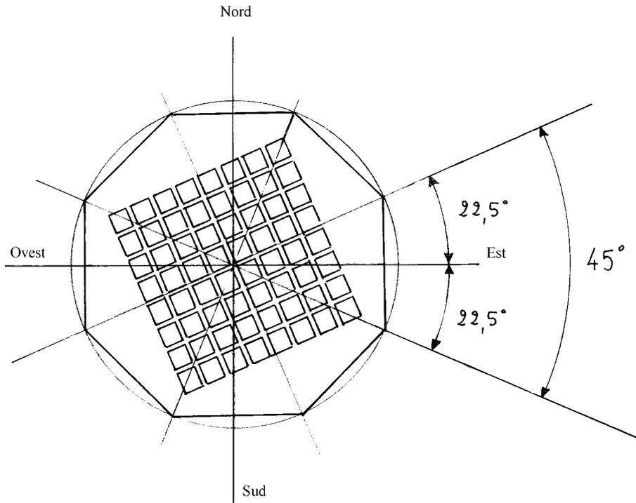
Vitruvio propose di ruotare l'orientamento delle strade di  $22,5^\circ$ , angolo che ricavò dalla divisione in due dell'angolo di  $45^\circ$  sotteso da un lato dell'ottagono ( $360/8 = 45^\circ$ ).
