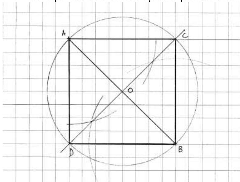
Determinare il punto medio della diagonale AB: è O. Tracciare la perpendicolare a AB nel punto O (asse del segmento AB).
