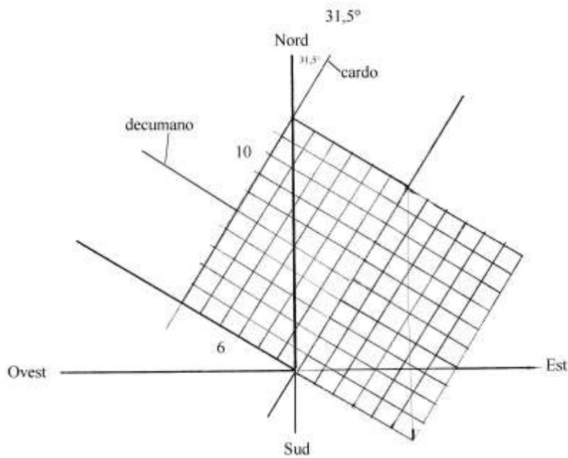
Il diagramma che segue mostra la sovrapposizione delle due precedenti griglie: esso è stato ottenuto facendo coincidere le due *diagonali* con l'asse Sud – Nord: la griglia 7x10 è tracciata con linea *continua* e quella 6x10 è disegnata con linea *tratteggiata*:
