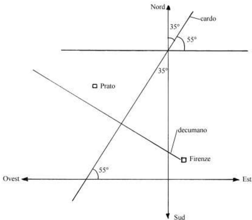
L'inclinazione di  $35^\circ$  era ottenuta usando una griglia rettangolare con lati lunghi 7 e 10: la tangente dell'angolo di  $35^\circ$  è, con buona approssimazione, uguale a  $7/10$  (o  $0,7$ ):
