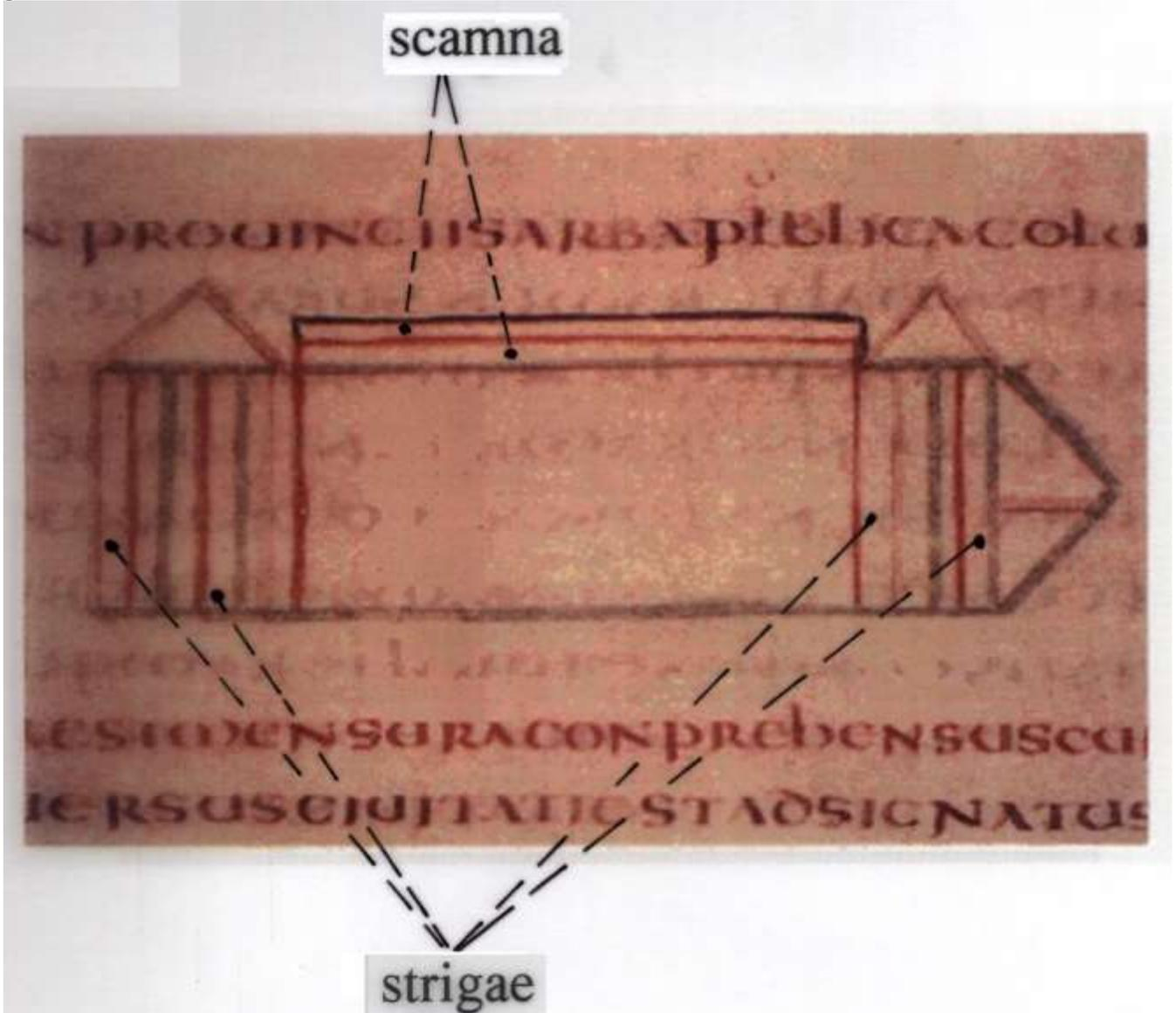
Le strisce rettangolari della *scamnatio* e della *striga* erano spesso organizzate in più grandi forme quadrate, che potevano risultare con i lati paralleli o perpendicolari rispetto a un asse (ad esempio un *decumano* perfettamente allineato lungo la direzione Est – Ovest):
