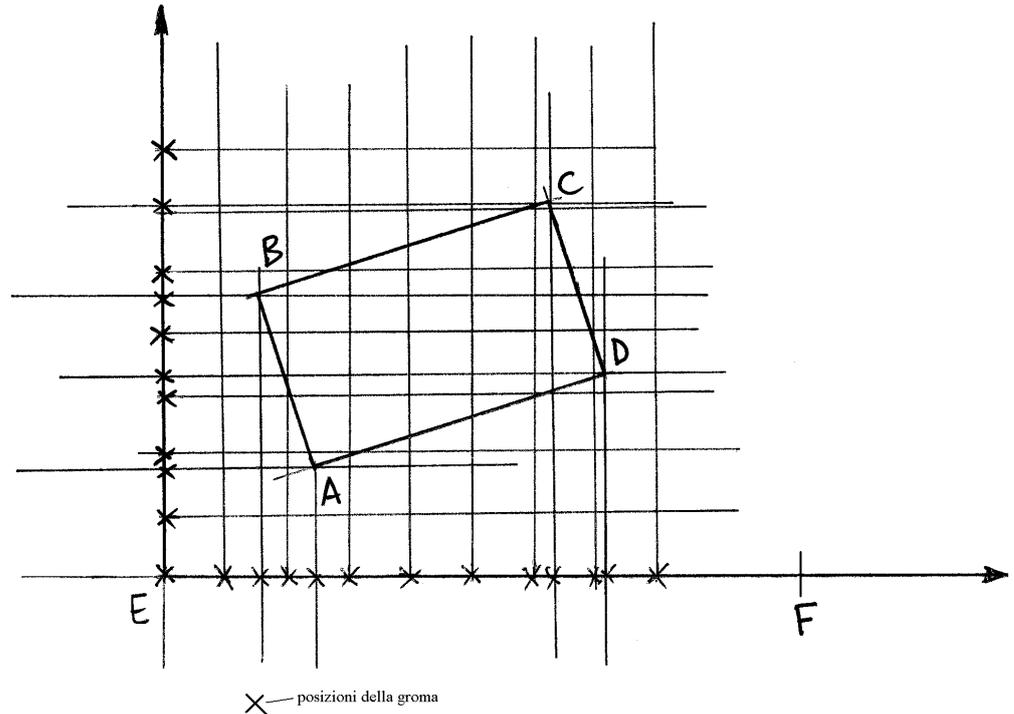
Dal punto E è tracciata una linea perpendicolare alla retta passante per E e per F. L'operazione poteva essere facilmente realizzata con la groma, che al suo vertice aveva un *goniometro* in grado di misurare soltanto angoli retti.
