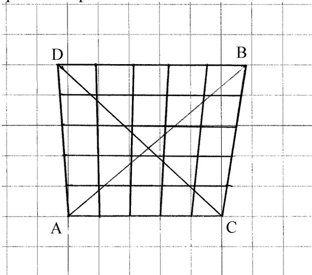
Verificando le due diagonali con la groma era evidente come esse non passassero per i vertici delle singole particelle quadrangolari.
