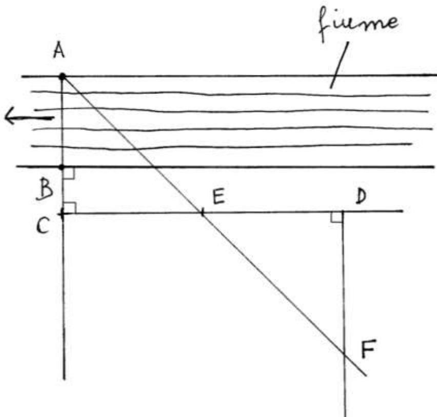
Dopo aver scelto il punto A e conficcatavi una palina nell'alveo del fiume, veniva fissato il punto B in modo che la retta immaginaria passante per i punti A e B risultasse perpendicolare al corso del fiume e alle rive.
