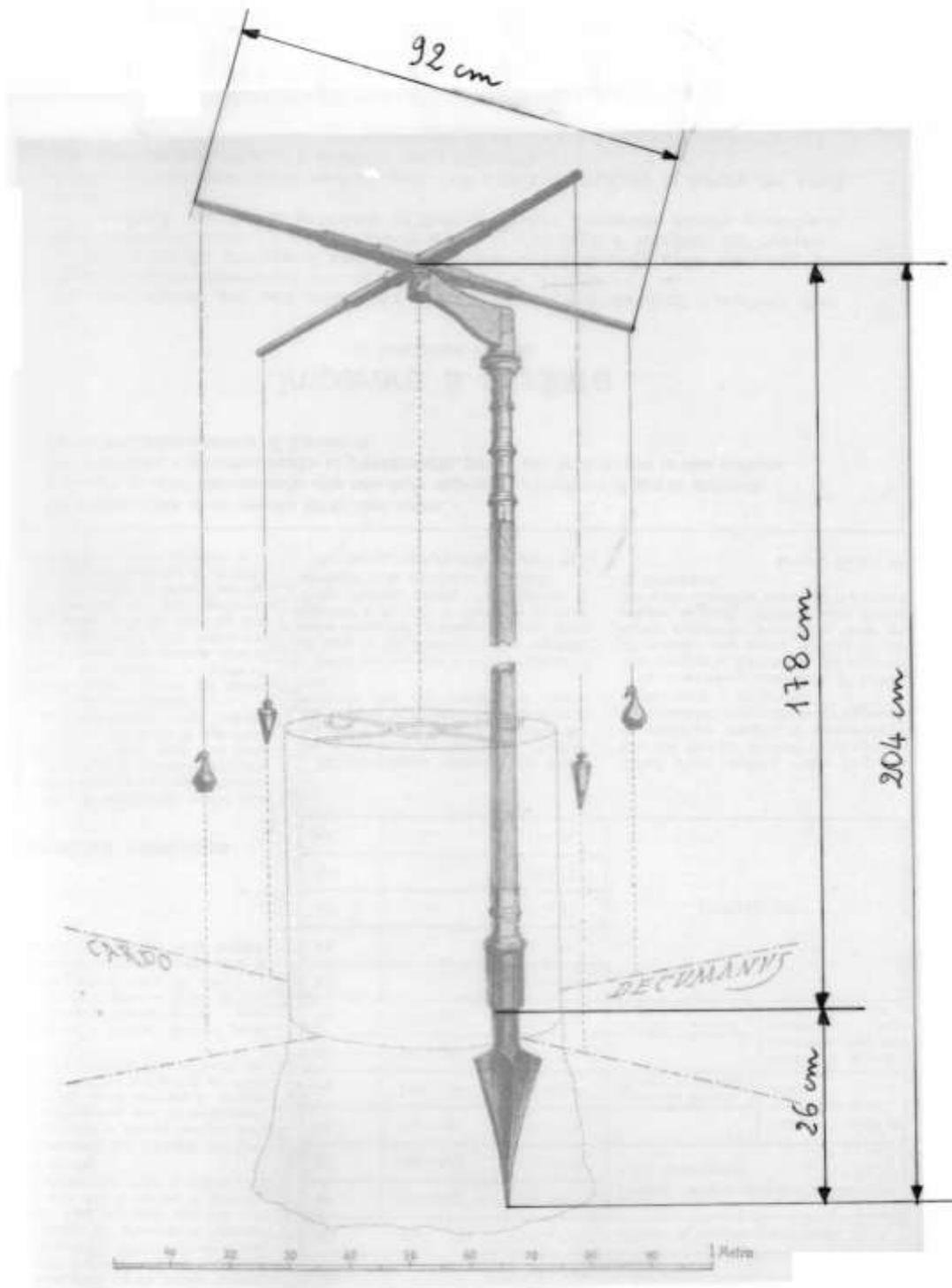
La groma era formata da 11 pezzi, di legno, bronzo e ferro (acciaio). Secondo Della Corte le parti metalliche pesavano 12,15 kg e quelle di legno 3 kg, per un peso complessivo di 15 kg. La groma era scomponibile per essere più facilmente trasportabile.
