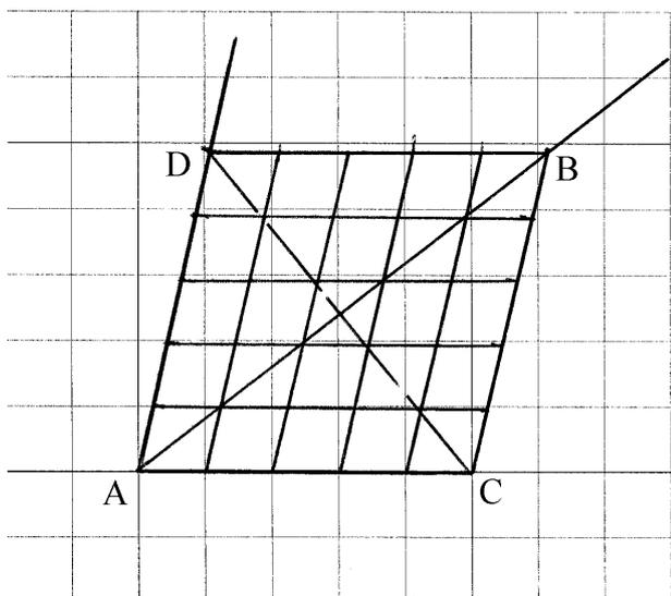
Entrambe le diagonali passavano per i vertici delle particelle. La misura delle lunghezze delle due diagonali era l'ulteriore passo necessario per verificare la precisione e segnalare l'errore: AB era manifestamente *più lunga* di CD.
